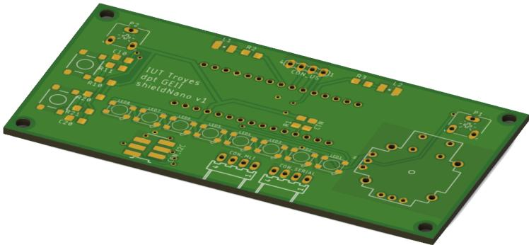
Le **circuit imprimé** ou **PCB** (Printed Circuit Board) est le support pour les composants électroniques.
